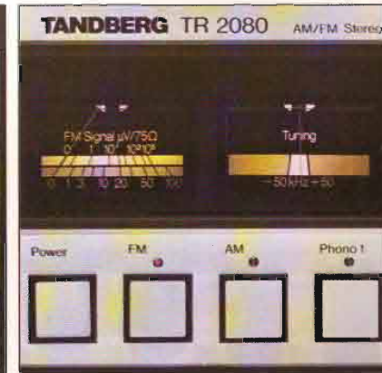
Store viserinstrumenter. TR 2080 har to viserinstrumenter: Signalstyrkeinstrumentet gir fullt utslag først ved kraftige antennesignaler (200 mV). Det kan også brukes til å lese av utgangseffekten. Senterinstrumentet gjør det lett å stille FM-stasjonene nøyaktig inn og er spesielt viktig ved stereosendinger.
